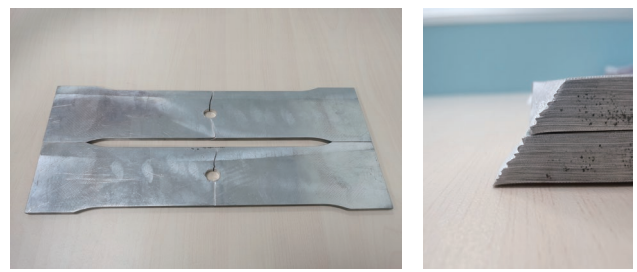
(a) 正面断裂位置 (b) 侧面断裂位置
